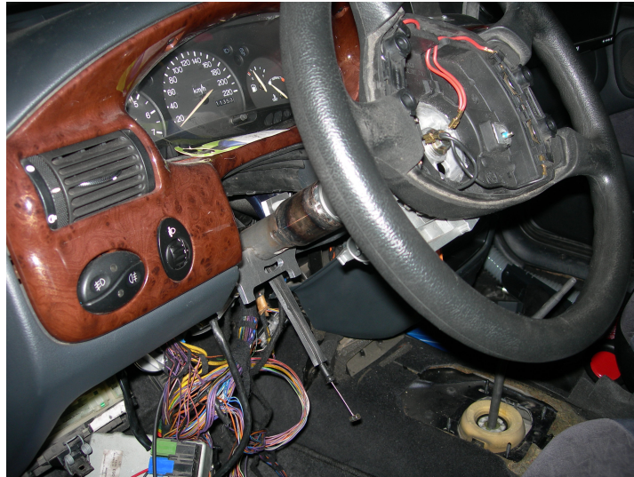
Figura 8: Instalação Definitiva da Coluna
